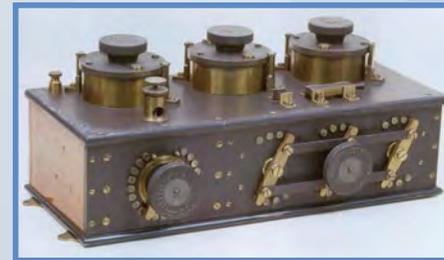
"Marconi-Franklin Multiple Tuner, questo dispositivo permetteva una sintonia multipla migliorando la qualità del segnale ricevuto. Questo dispositivo, inventato e brevettato nel 1907 era all'avanguardia e installato sulle navi più importanti del periodo (Milano, Museo Nazionale della Scienza e della
